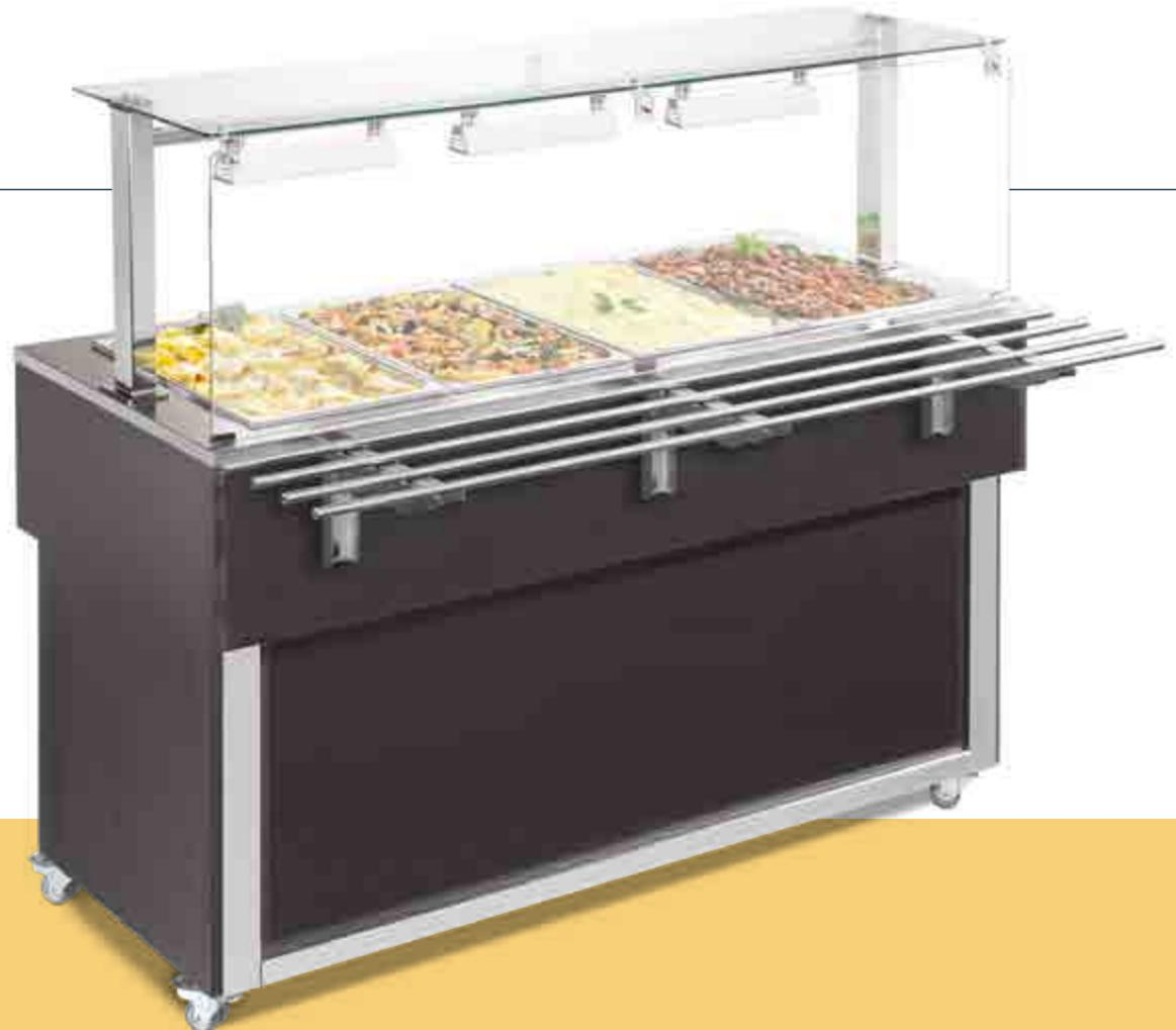
Isole del Servizio con vasca calda bagnomaria con fondo arrotondato e diamantato per agevolare lo scarico dell'acqua per una perfetta pulizia ed igiene, per il contenimento di vaschette GN1/1 (max H 200mm).
